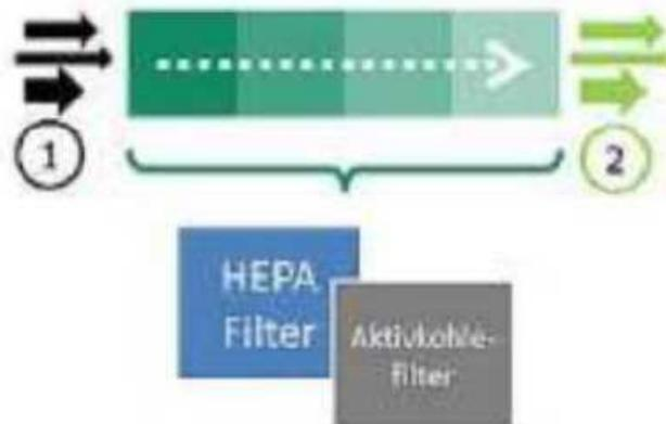
Die aus dem Beutel und aus dem Innenbereich der Maschine abgesaugte Luft (1) wird sofort durch den HEPA- und Aktivkohlefilter geleitet und gereinigt.
